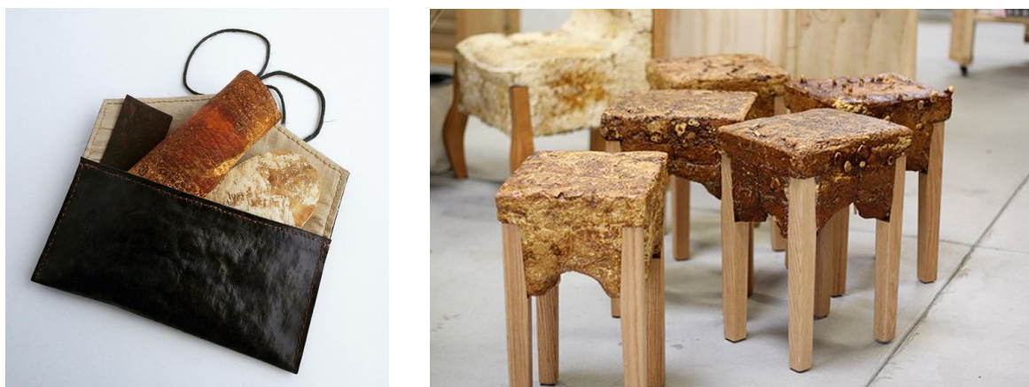
Obrázek 18 Ukázka využití materiálu MycoWorks v praxi – 1. šitý doplněk, 2. nárůst materiálu do 3D tvaru, židle (Zdroj: archiv MycoWorks, 2018)
