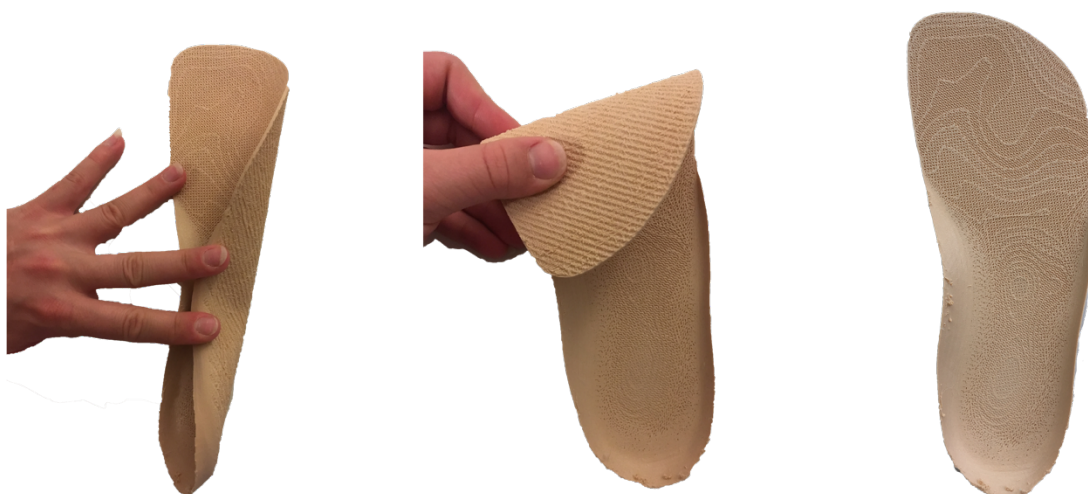
Obrázek 73 Vkládací stélka vytištěná na 3D tiskárně Ultimaker. Doba tisku 9 hodin. Materiál flexibilní filament Flexfill 98A, flexibilní s otvory pro zajištění prodyšnosti (Zdroj: vlastní archiv, 2019)
