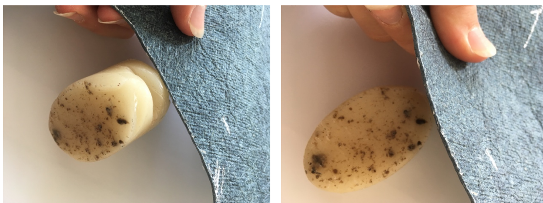
Obrázek 39 Zapravování okrajů včelím voskem – před a po aplikaci vosku (Zdroj: vlastní archiv, 2019)
