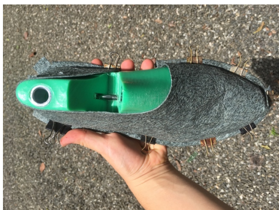
Obrázek 41 Tvarování materiálu Malai zasucha, napařování, zapékání v troubě na 150 °C (Archiv: vlastní, 2018)
