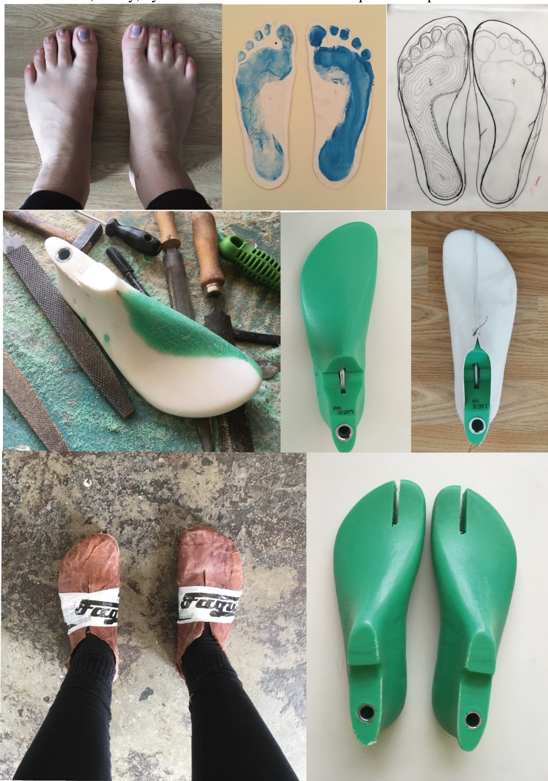
Obrázek 59 Výroba kopyta tradičním způsobem (otisk, obrys, rašple, zkušební sáček) (Zdroj: vlastní archiv, 2019)
