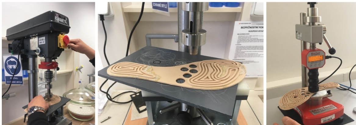
Obrázek 68 Výřez vzorky pro testování elastomeru a měření tvrdosti pomocí Tvrdoměru (zdroj: Vlastní archiv, 2019)
