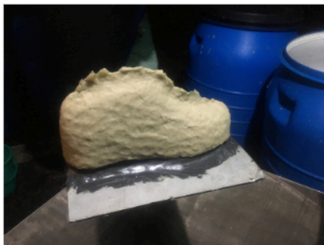
Obrázek 40 3D formování materiálu Malai, nárůst materiálu přímo na formu (Zdroj: Archiv Malai Biomaterials, 2018)
