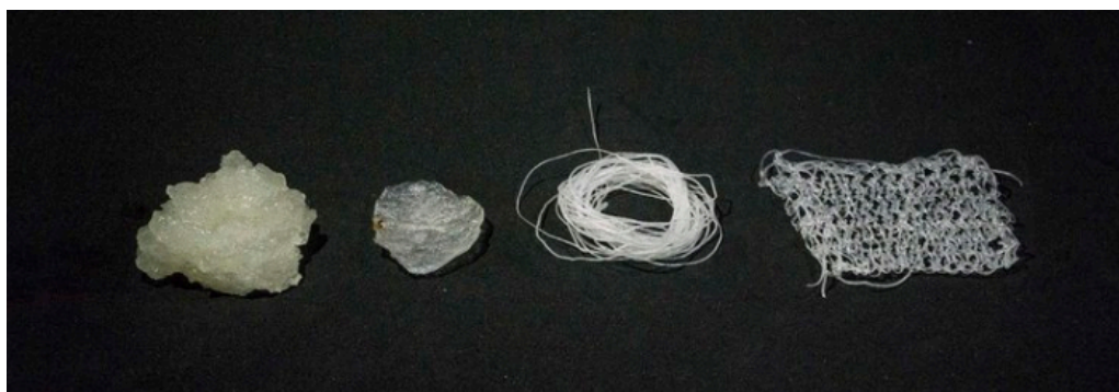
Obrázek 6 Proces výroby textilie: transformace bio materiálu v podobě pasty (biopolymer „Alginate“) získané z mořských řas do monofilamentu (příze) a její následné zpracování do podoby textilie (Algiknit, 2018).
