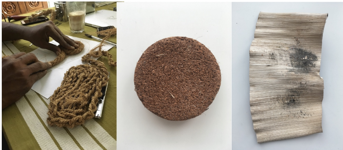
Obrázek 66 Přírodní zdroje pro výrobu podešví a) splétané kokosové lano v kombinaci s latexem, viz str.62 prototyp obuvi, b) směs přírodního kaučuku, kokosového prachu a vláken c) Palmový list Areka (zdroj: Vlastní archiv)
