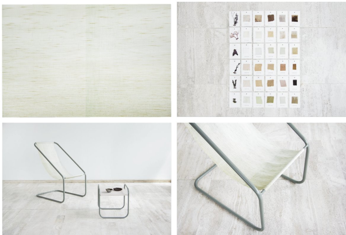
Obrázek 8 Sea Me Collection: vzorek materiálu splétaného z příze na bázi mořských řas, barevná škála materiálu, demonstrace využití materiálu při tvorbě nábytku se vznikem nulového odpadu (Zdroj: archiv Studio Nienke Hoogvliet, 2018).
