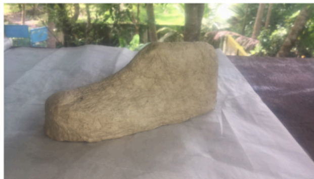
Obrázek 40 3D formování materiálu Malai, nárůst materiálu přímo na formu (Zdroj: Archiv Malai Biomaterials, 2018)
