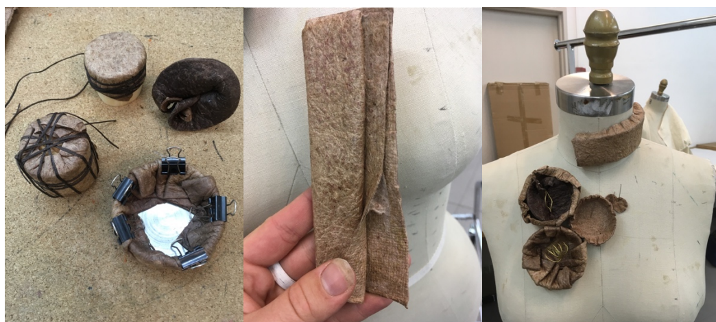
Obrázek 42 Tvarování materiálu Malai za mokra, tzv. Wet moulding (Zdroj: vlastní archiv, 2018)
