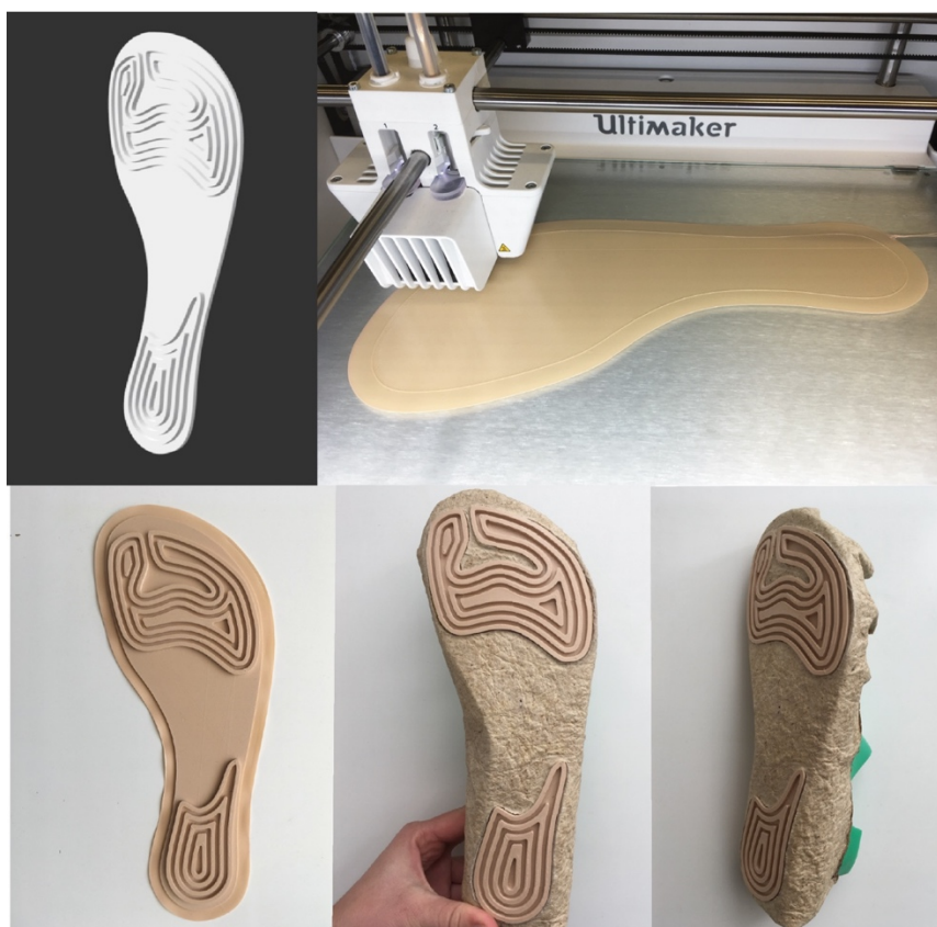
Obrázek 65 Využití 3D tisku pro výrobu flexibilních podešví (Zdroj: vlastní archiv, 2019)
