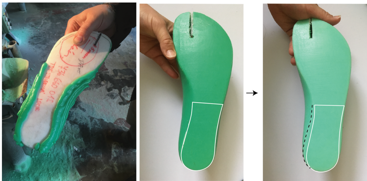
Obrázek 67 Úprava kopyta v nášlapné části (zdroj: vlastní archiv, 2019)
