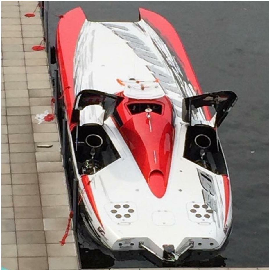
Obr. 7. Pohľad na turbínové motory závodného katamaránu
