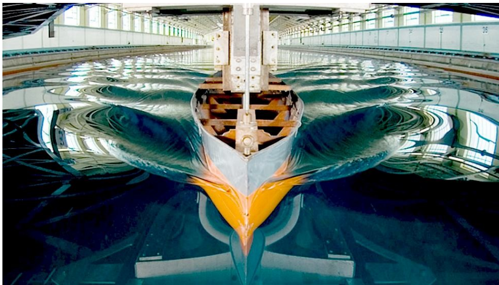
Obr. 20. Hydrodynamická skúška zmenšeného modelu v k tomu určenej nádrži
