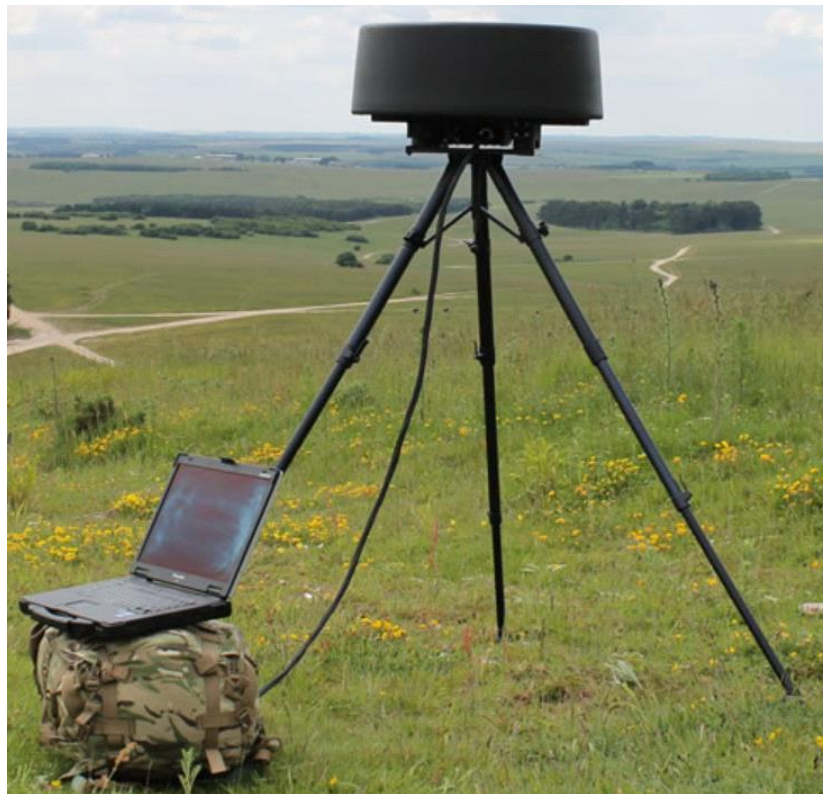
Obrázek 34 Radarový systém pro ochranu perimetru utábořené jednotky. [49]
