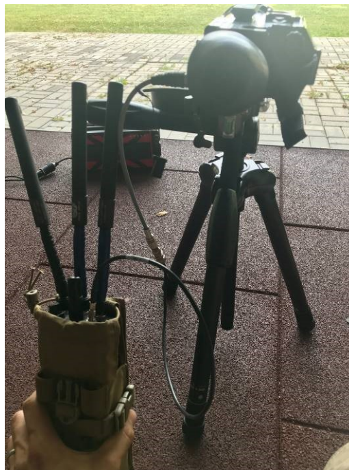
Obrázek 18. MPU5 přenos obrazu termovizního pozorovacího prostředku [vlastní]
