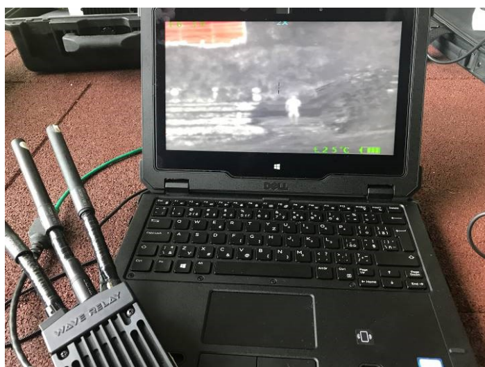
Obrázek 19. MPU5 příjem obrazu na odolném notebooku [vlastní]
