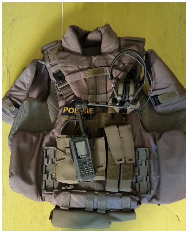
Obrázek 1. Neprůstřelná vesta ZJ osazena stanicí TPH 900 [vlastní]
