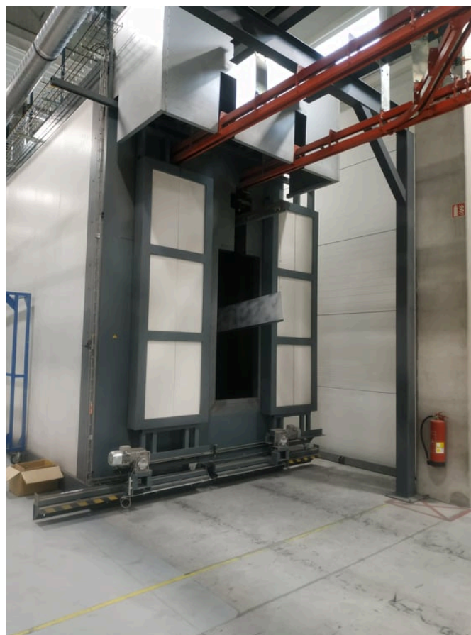
Obrázek 16: Výstup materiálu z lázni (Zdroj vlastní)
