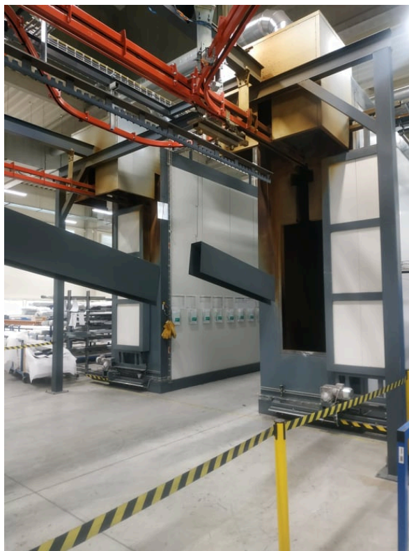
Obrázek 18: Nalakovaný materiál vjíždící do pece (Zdroj vlastní)
