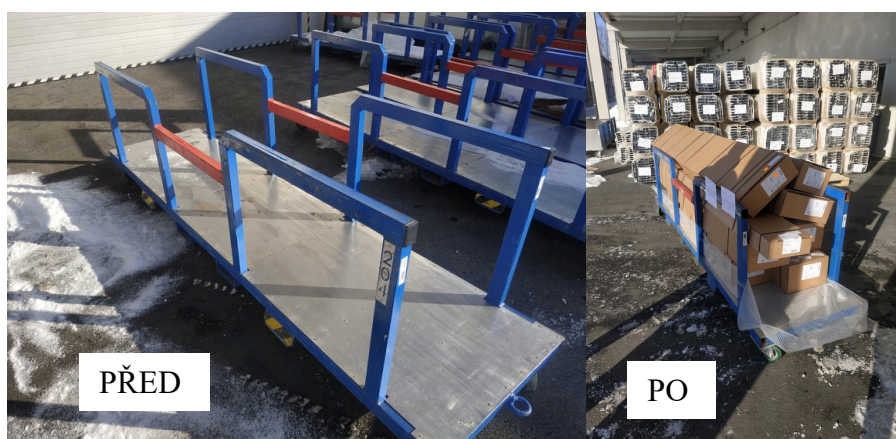
Obrázek 27: Vyztužení dna vozíku před a po (Zdroj vlastní)
