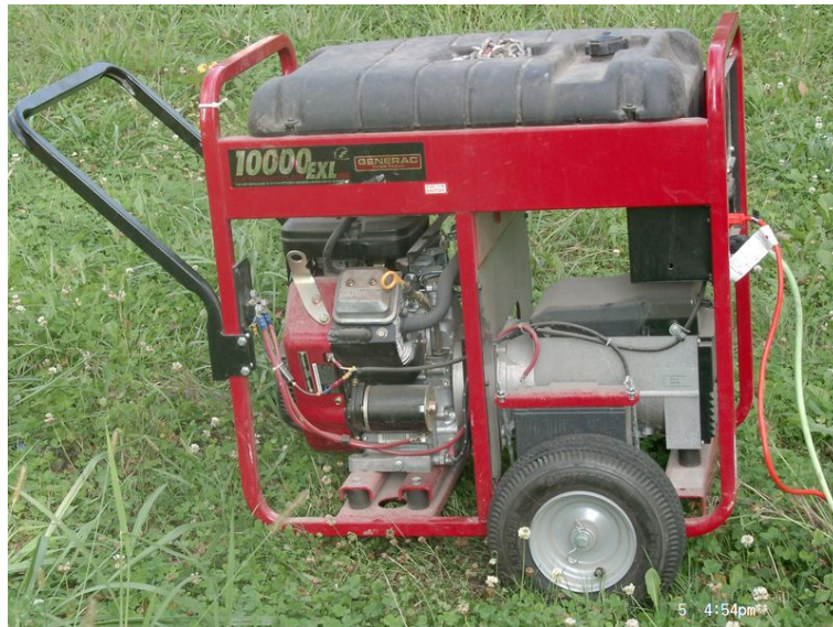
Obr. 11. Mobilní motor-generátor se spalovacím motorem
