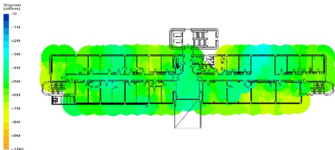
Obrázek 32 Výsledek měření ve druhém nadzemním podlaží po změnách (Vlastní zpracování)
