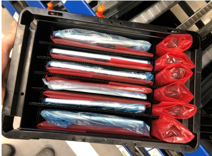
Obrázok 35 Materiál zabalený podľa nesprávneho baliaceho predpisu (vlastné spracovanie)
