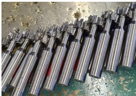
Obrázek 35 Zhotovené ozubení na polotovarech (vlastní zpracování)
