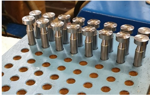
Obrázek 33 Zhotovené polotovary fréz s vybráním na čele (vlastní zpracování)
