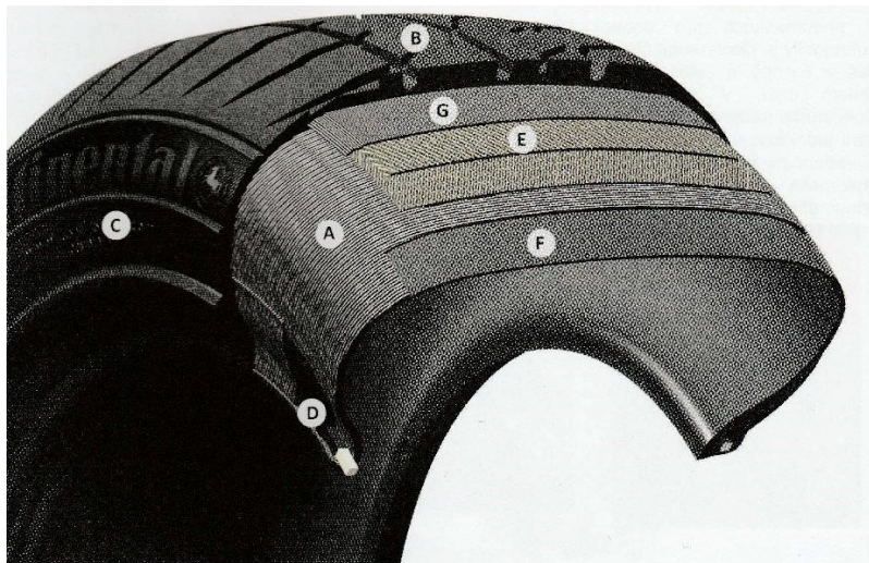
Obrázek 4 Průřez pláštěm (interní materiály)
