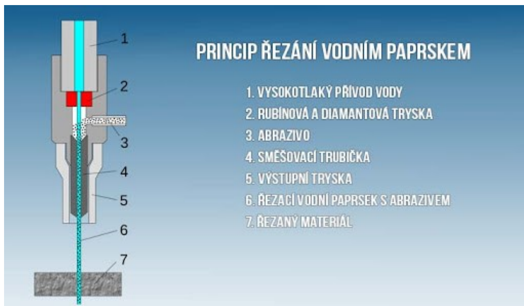
Obr. 4 Řezání vodním paprskem (rezani-cnc.cz, 2016)
