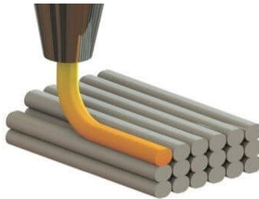
Obr. 1 – Aditivní výroba, nánášení materiálu vrstvu po vrstvě [6]
