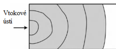
Obrázek 3 Plnění dutiny formy [11]
