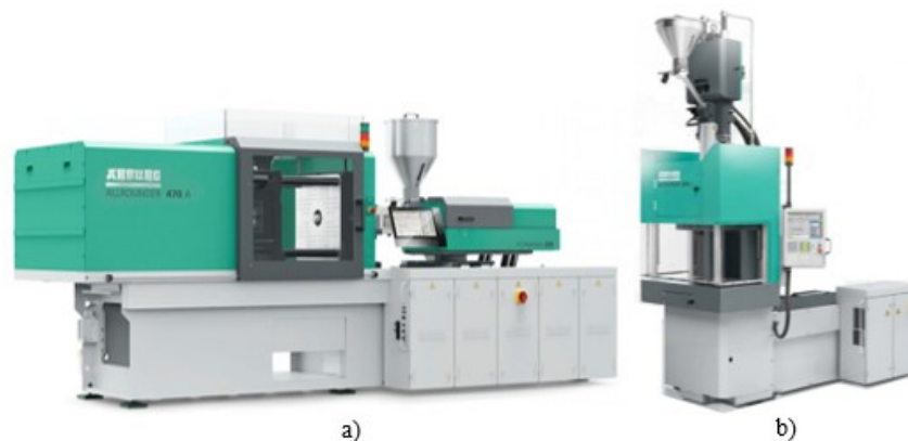
Obrázek 7 Vstřikovací stroj a) horizontální b) vertikální [23]
