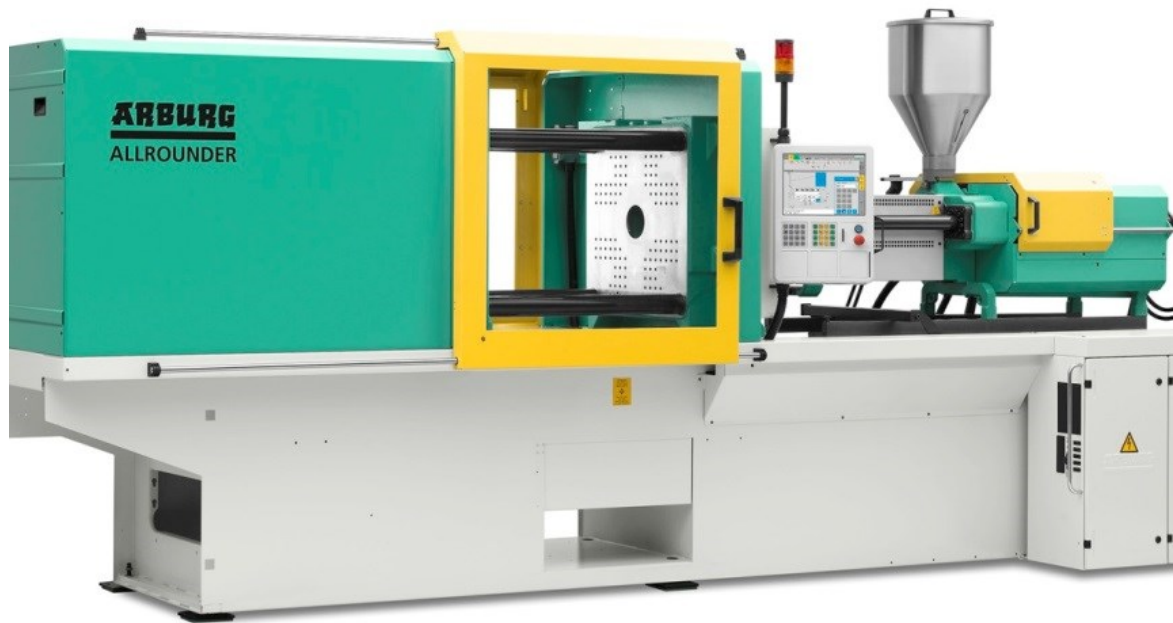
Obr. 44 Vstřikovací stroj Arburg ALLROUNDER 570C [38]
