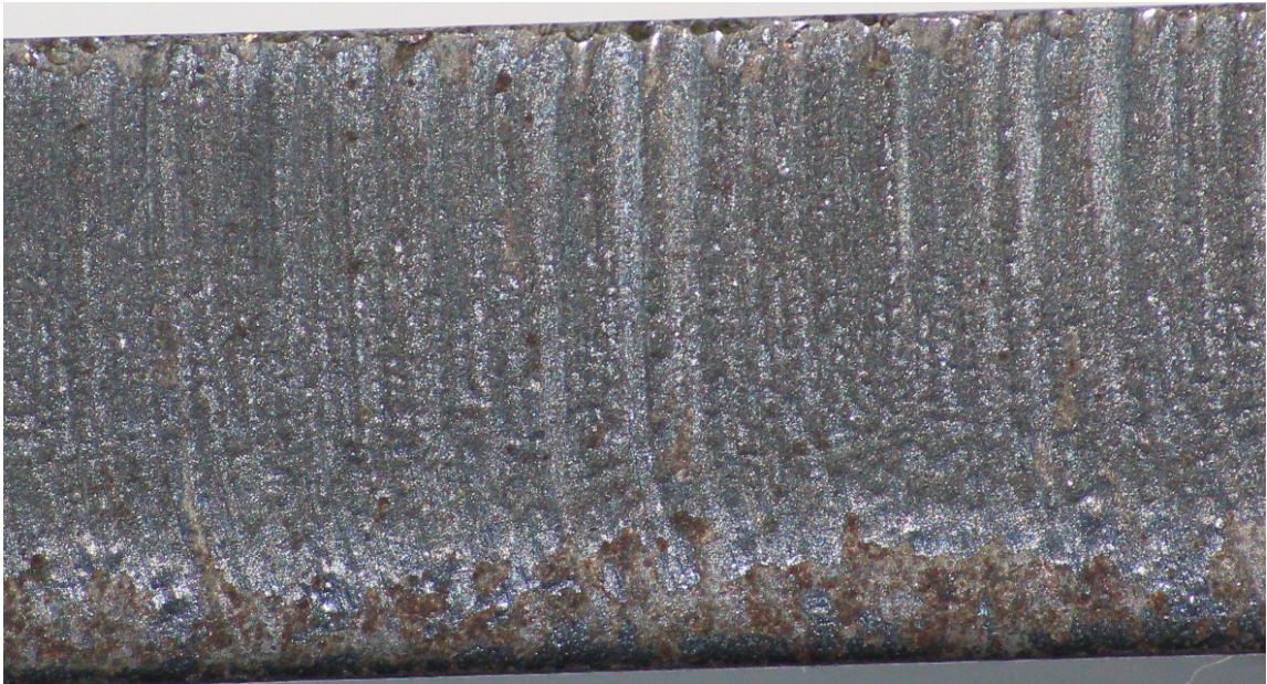
Obrázek 26. Povrch vzorku 10 mm řezaný plazmou
