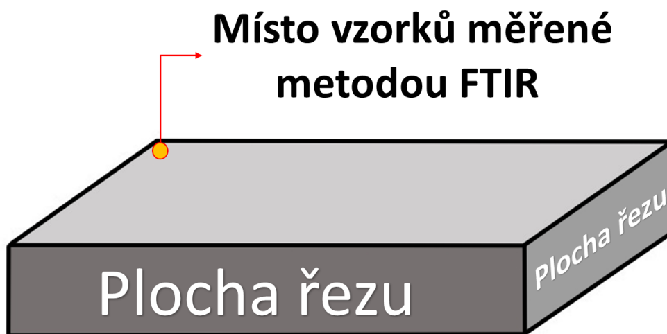
Obr. 7.2 Oblast zkoumaného vzorku pro měření FTIR.
