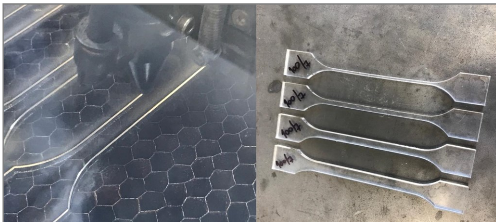
Obr. 24 Řezání vzorků pro zkoušku tahem
