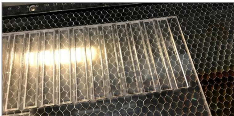
Obr. 25 Řezání vzorků pro zkoušku ohybem
