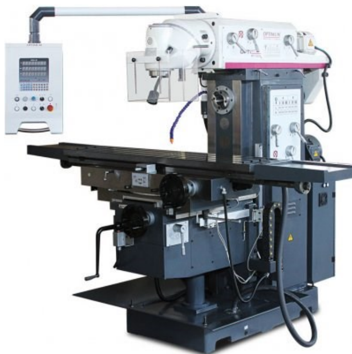
Obr. 15 Univerzální frézka OPTImill MT 230 S [13]
