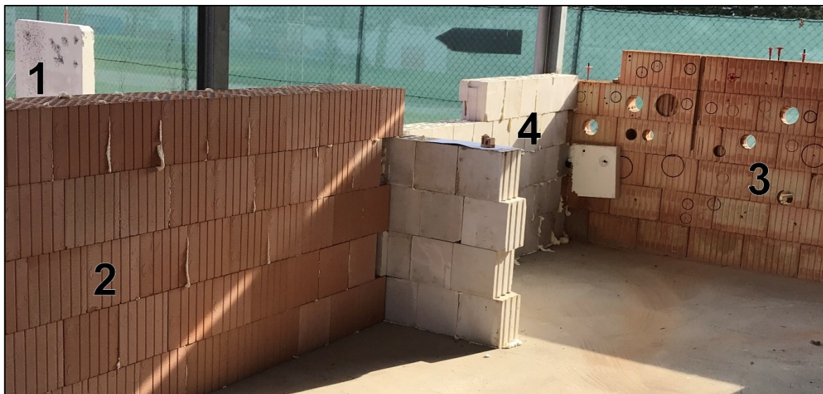
Obrázek 36. Zkušební zdi pro drážkování, (1 beton, 2 děrovaná cihla Porotherm, 3 akustická cihla Porotherm, 4 vápenopísková abrazivní cihla).
