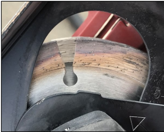
Obrázek 37. Zdeformovaný kotouč při střetu s výztuhou.
