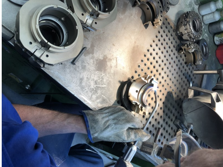
Obrázek 17. Navařování dělicí roviny.
