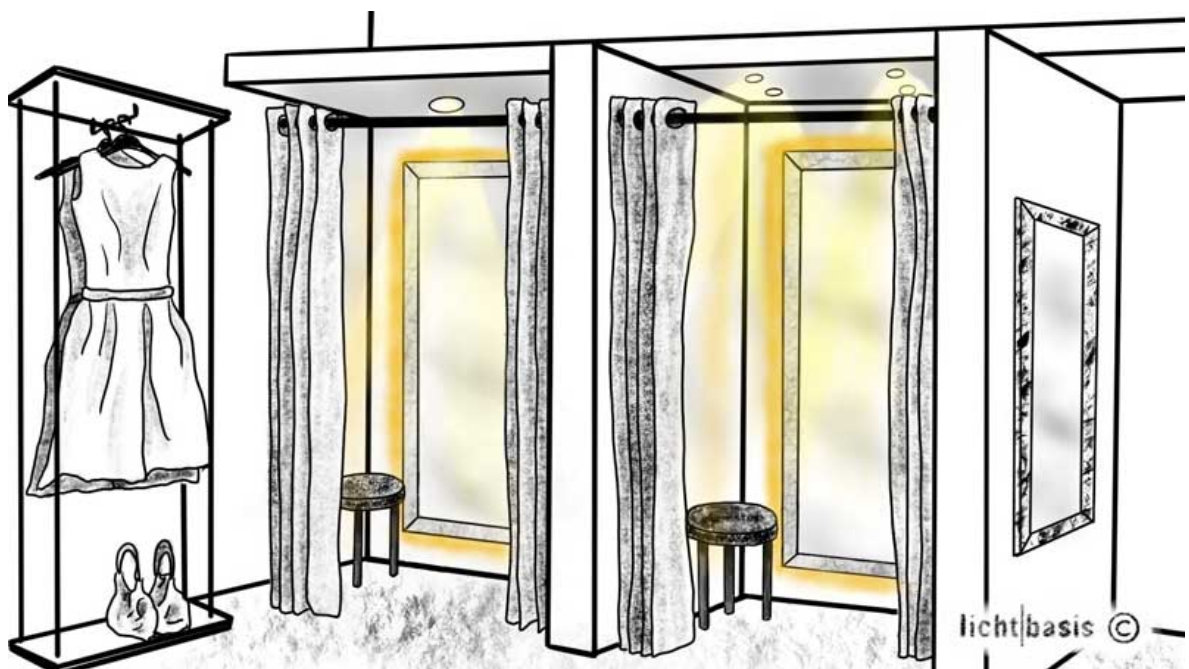
Obr. 31. Základné riešenie s jedným bodovým svetlom (ľavá kabínka), ideálne riešenie so štyrmi bodovými svetlami (pravá kabínka)
