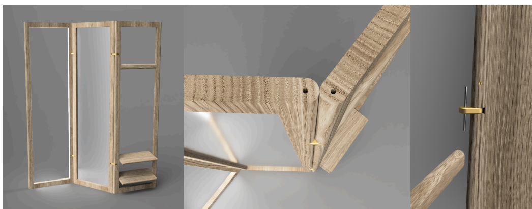
Obr. 67. Vizualizácie: Detail pántov
