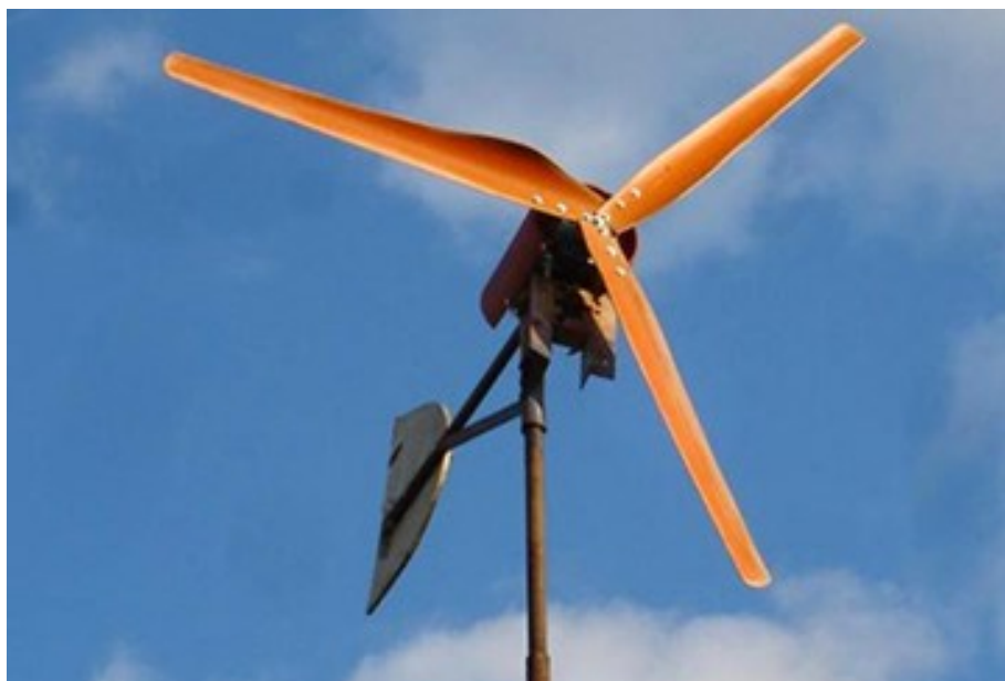
Obr. 9 Vrtulová větrná elektrárna s pomocným kormidlem [14]
