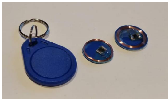
Obrázek 24 Upravené tagy S50 ve srovnání s tagem v originálním pouzdru
