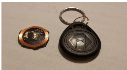
Obrázek 25 Vyjmutý tag ESES ve srovnání s tagem v originálním pouzdru
