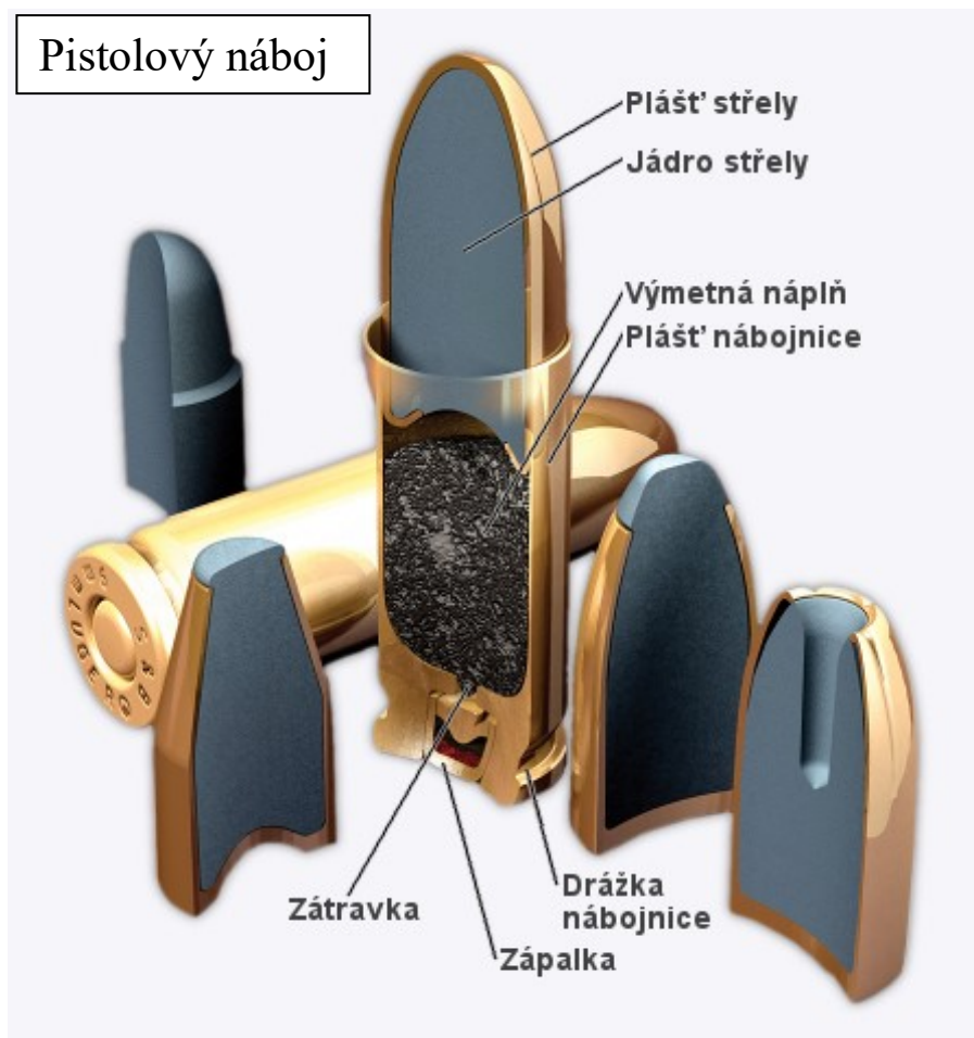
Obr. 2. Pistolový náboj a jeho popis [30]
