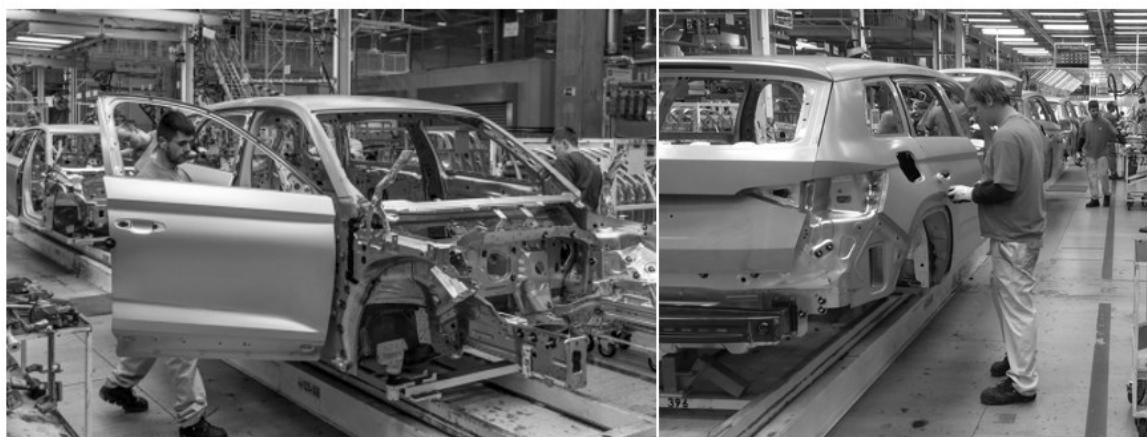
Obr. 37 Montáž a lícování dveří [22, 23]
