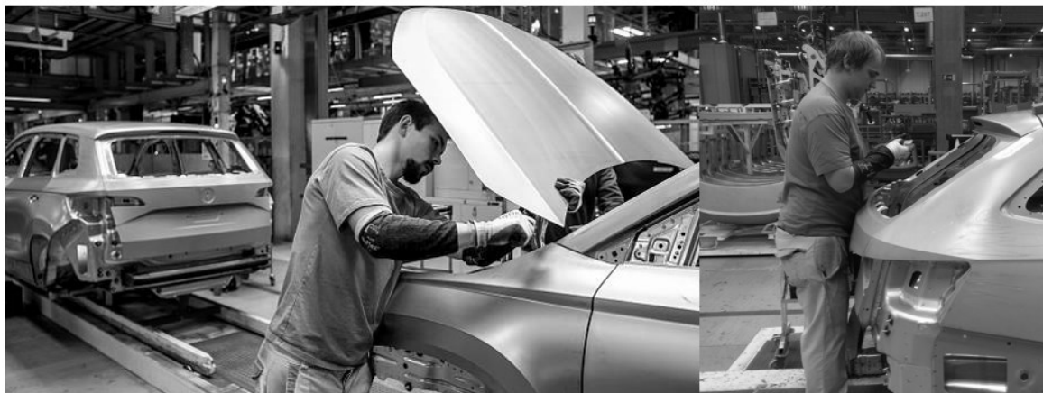
Obr. 38 Montáž kapoty a zadního víka [23, 24]
