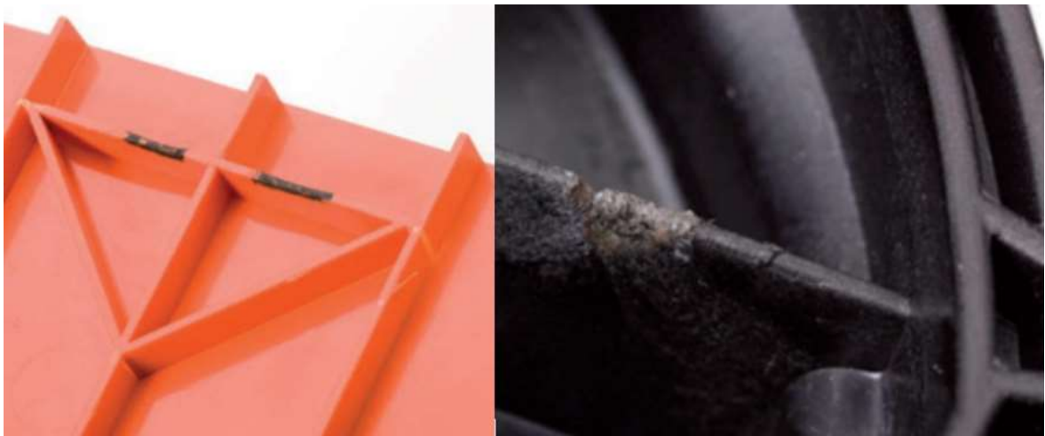
Obr. 17. Dieselefekt – spálený polymer v důsledku komprese vzduchu [15]
