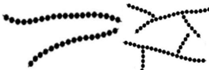
Obr. 1. Lineární (vlevo) a rozvětvené řetězce (vpravo)
