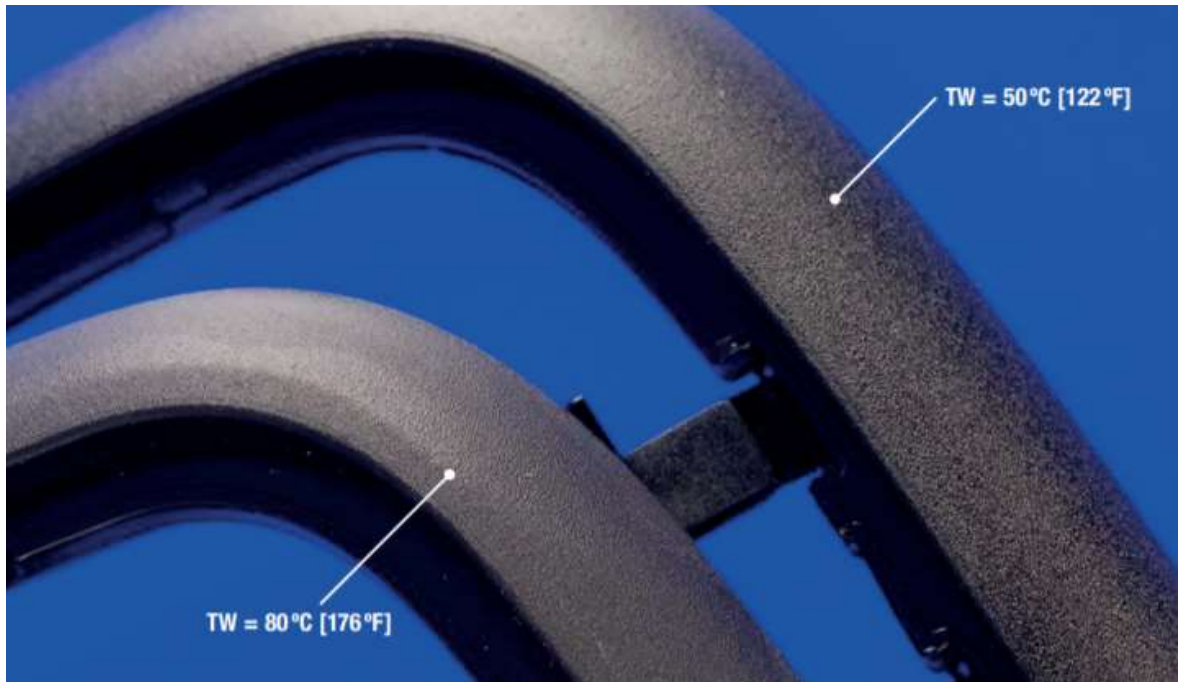
Obr. 22. Vliv teploty formy ( TW ) na lesk výrobku [15]
