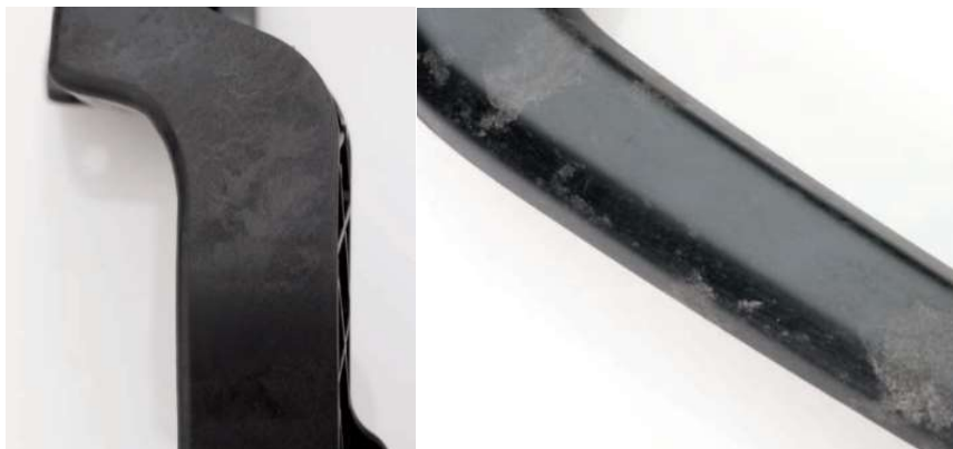
Obr. 24. Stříbření způsobené skelnými vlákny [15]
