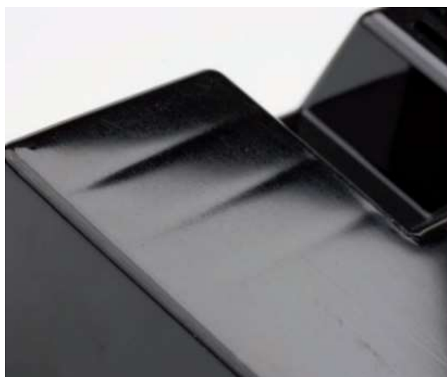
Obr. 20. Propadliny na výrobku vzniklé nevhodnou konstrukcí žeber [15]
