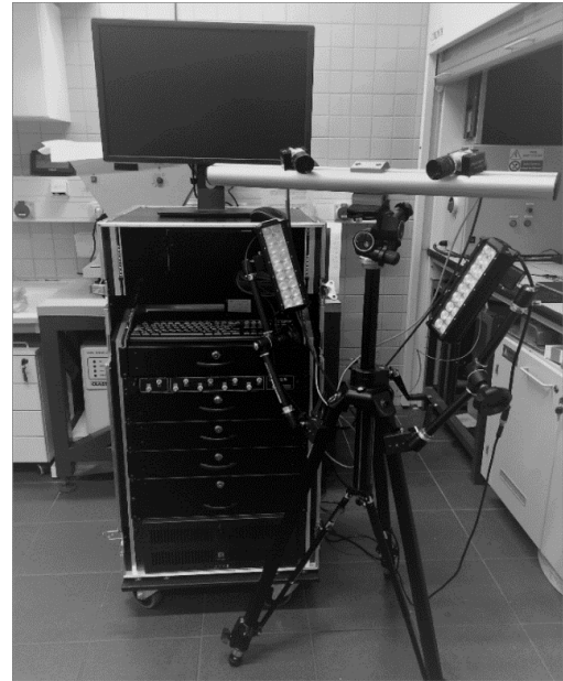
Obr. 69 Kamerový systém na měření DIC
