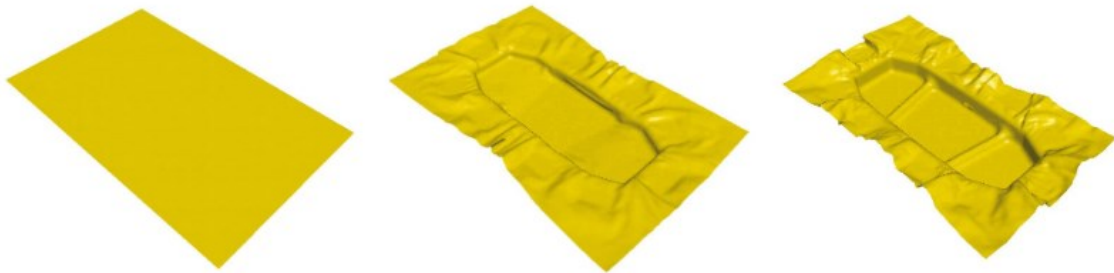
Obr. 40 Příklad simulace v programu PAM-COMPOSITE
