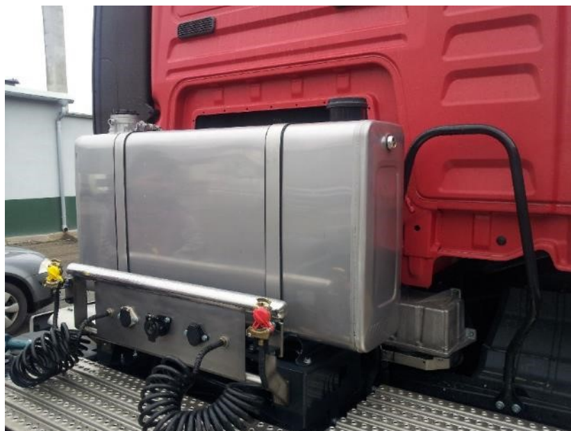
Obrázek 10 Nádrž namontovaná za kabinou řidiče [19]
