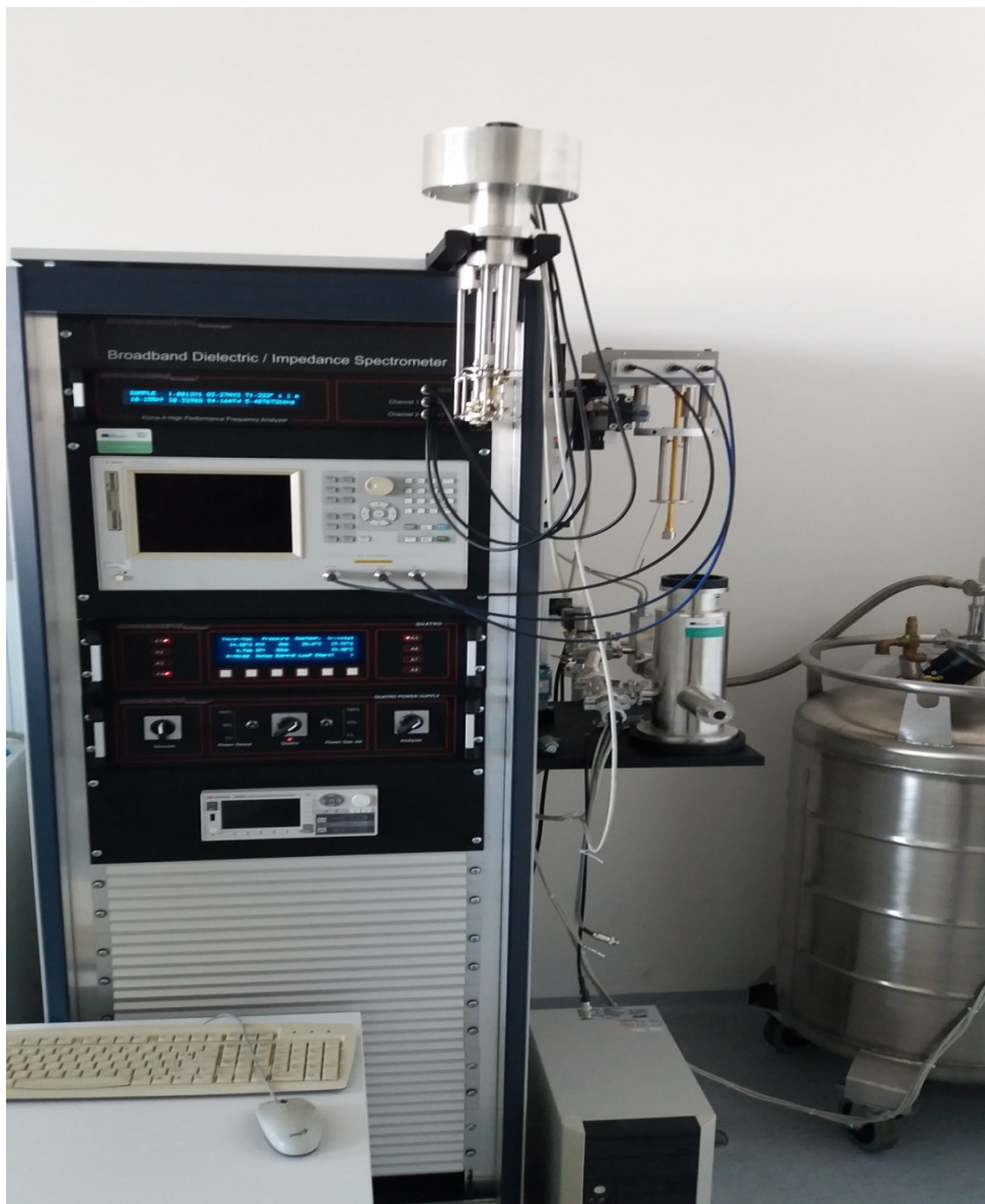
Obr. 18: Soustava pro měření dielektrických vlastností
