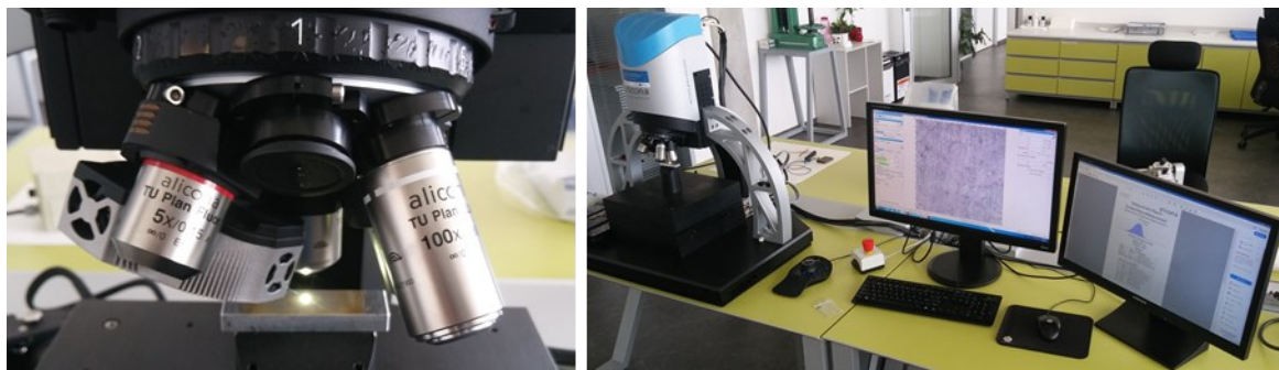
Obr. 15. Měření drsnosti na přístroji Alicona InfiniteFocus G5 plus
