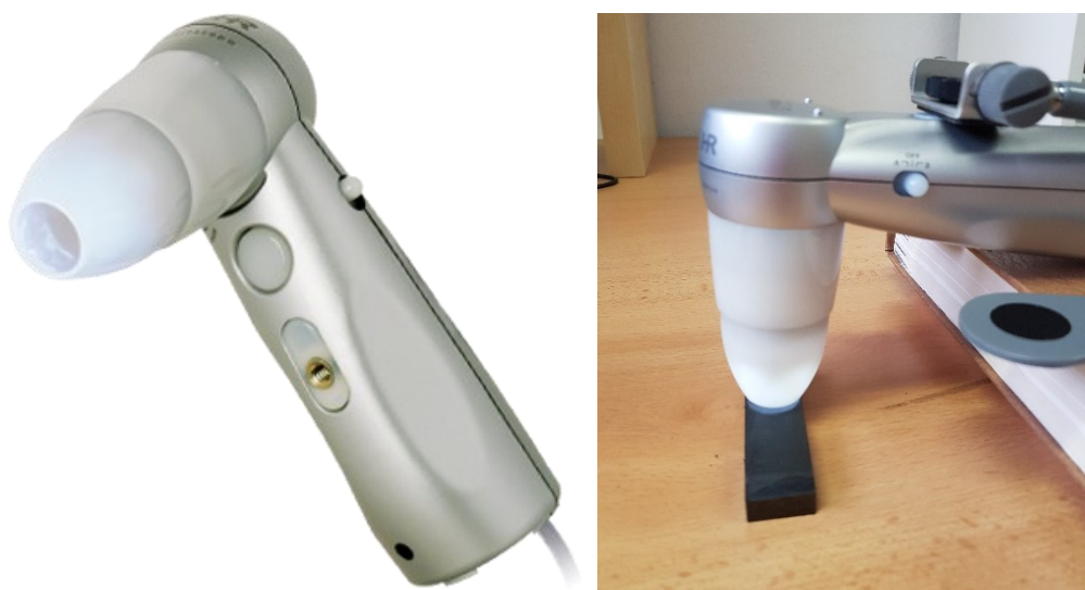
Obr. 16. Mikroskop ProScope HR a pořízení mikroskopického snímku na zkušební destičce
