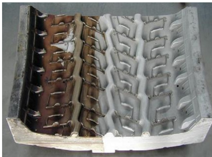
Obr. 11. Lisovací forma částečně znečištěna, částečně vyčištěna laserem [32]
