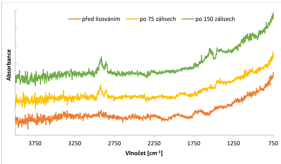
Obr. 40. Srovnávací graf analýz FTIR zkušební destičky 1.2343 Sigaan před lisováním, po 75 lisovacích cyklech a po 150 lisovacích cyklech
