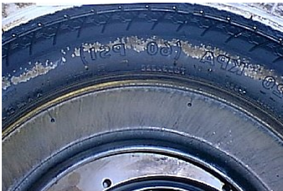
Obr. 9. Vada výrobku způsobena kontaminovanou formou [22]
