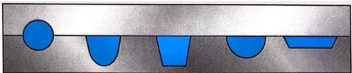
Obr. 7. Vhodné průřezy tokových kanálů [7]
