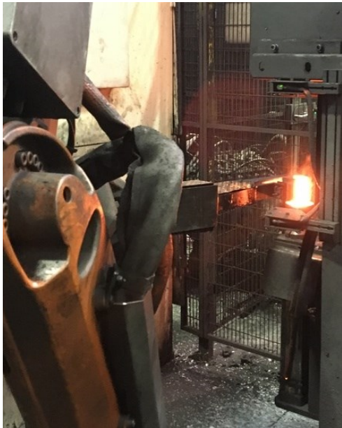
Obrázek 33 Rameno uchopující zahřátý přířez (vlastní zpracování)
