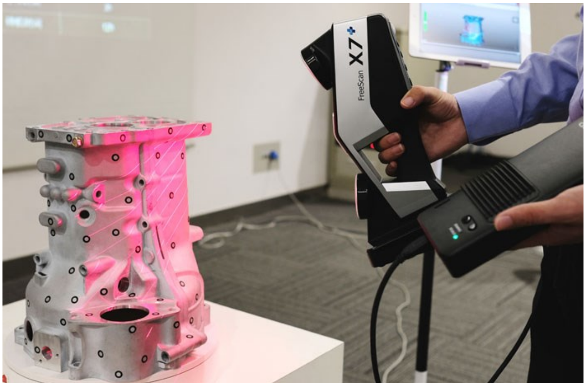
Obr. 2 Průběh 3D skenování objektu bezdrátovým skenerem (Shining 3D announces two wireless handheld 3D scanners, 2018)
