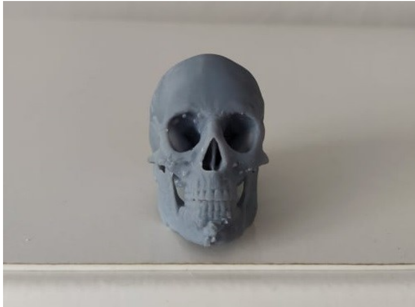
Obr. 27 Prototypový model lebky po mechanickém odstranění podpor (vlastní zpracování)
