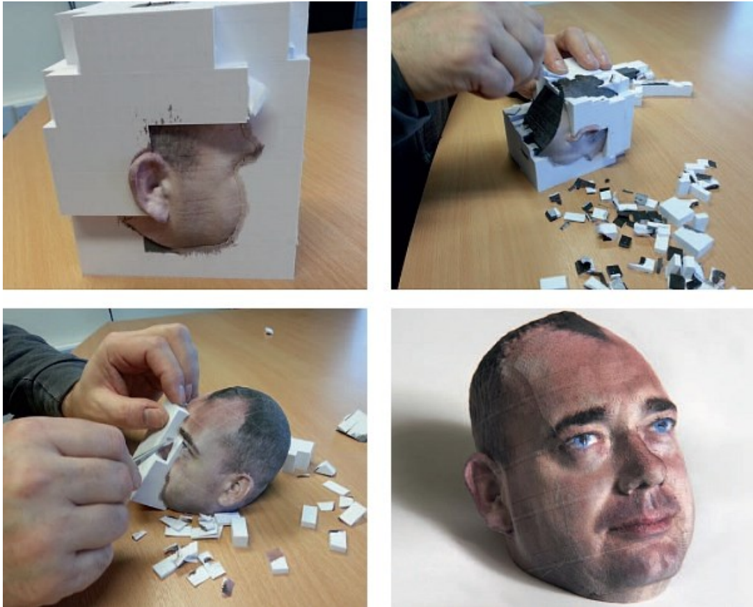
Obr. 6 Postprocessing aditivní metody LOM a jeho konečný výsledek (Daniel, 2013)
