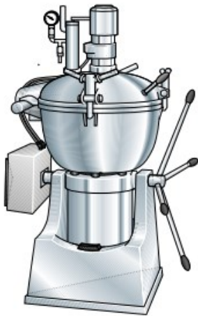
Obrázek 3: Tavička pro výrobu diskontinuálním způsobem, uzavřená [52]
