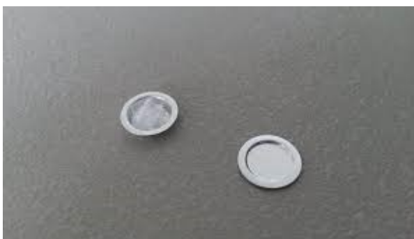
Obrázek 25. Hliníková pánvička se vzorkem pro DSC analýzu a víčko. [48]
