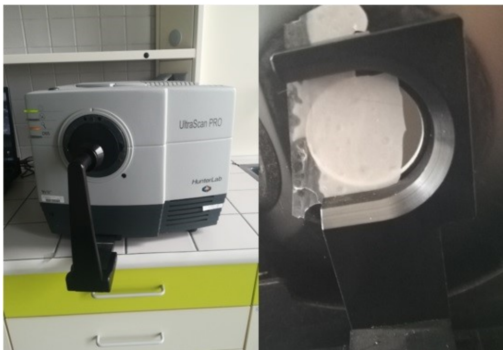
Obrázek 26. Spektrofotometr značky HunterLab využitý pro měření s detailem úchyty vzorku.
