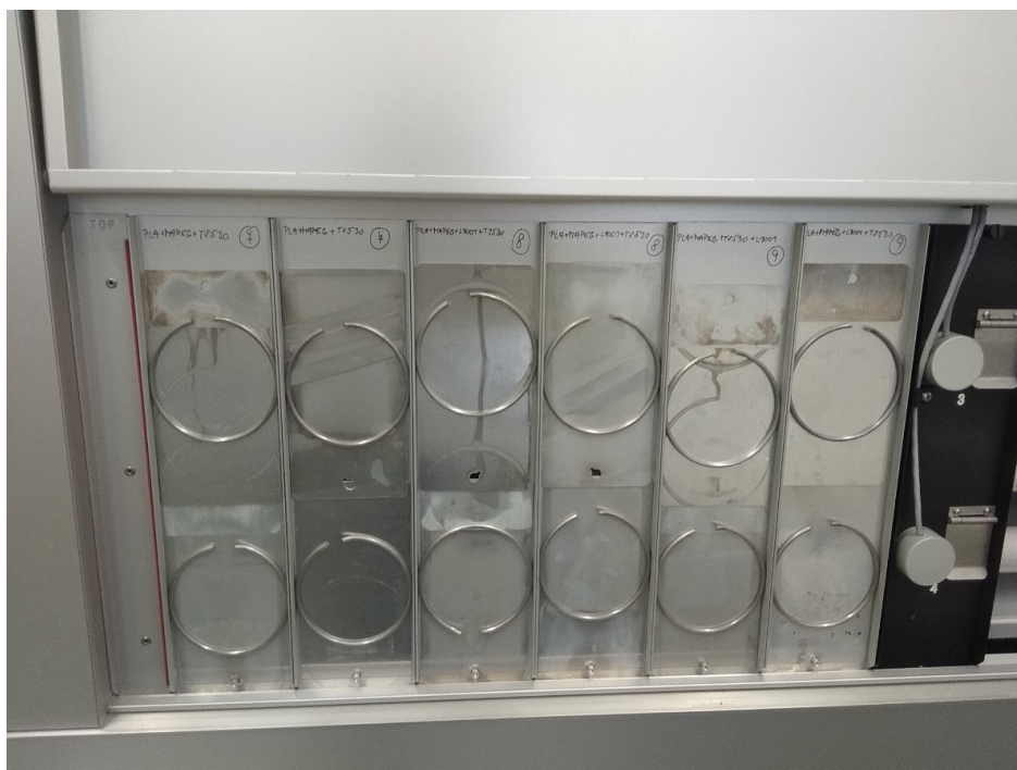
Obrázek 22. Uspořádání vzorků v přístroji QUV Accelerated Weathering Tester.
