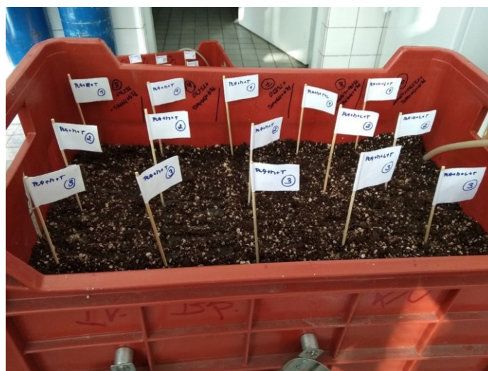
Obrázek 24. Půdní reaktor s uloženými vzorky k biodegradaci.
