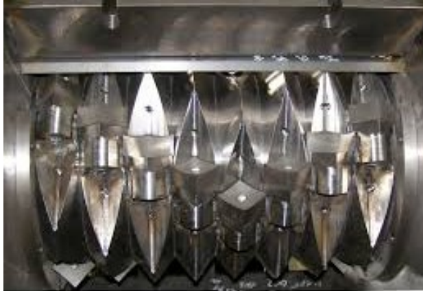
Obrázek 5 Jemné drcení plastových materiálů [11]
