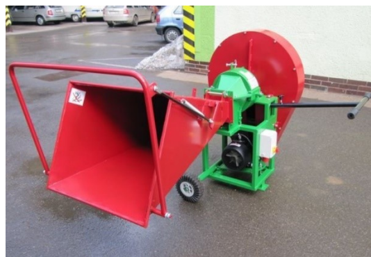
Obrázek 21 PIRANA štěpkovač s elektromotorem [30]
