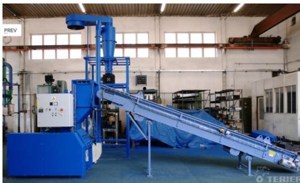
Obrázek 37 Nožový mlýn G 400 45kW [49]
