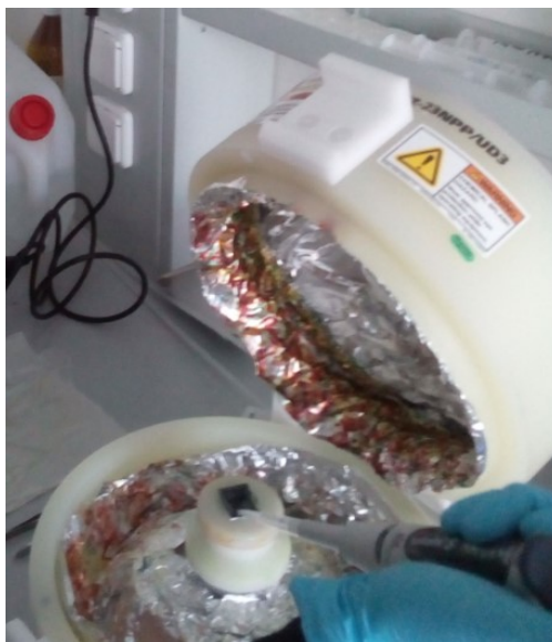
Obrázek 27: Aplikace roztoku polymeru na substrát
