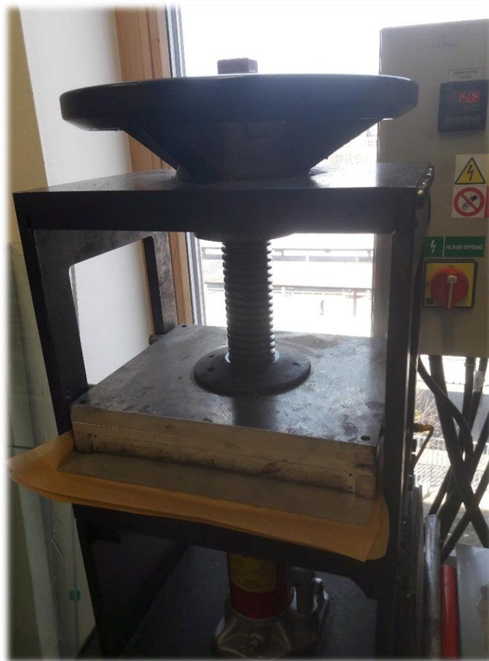
Obr. 29 Příklad lisování mezi vyhřívanými deskami
