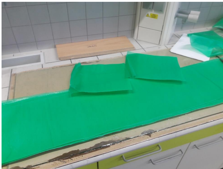
Obr. 27 Ukázka nastříhaných pásů a jednotlivých odstřížků před lisováním
