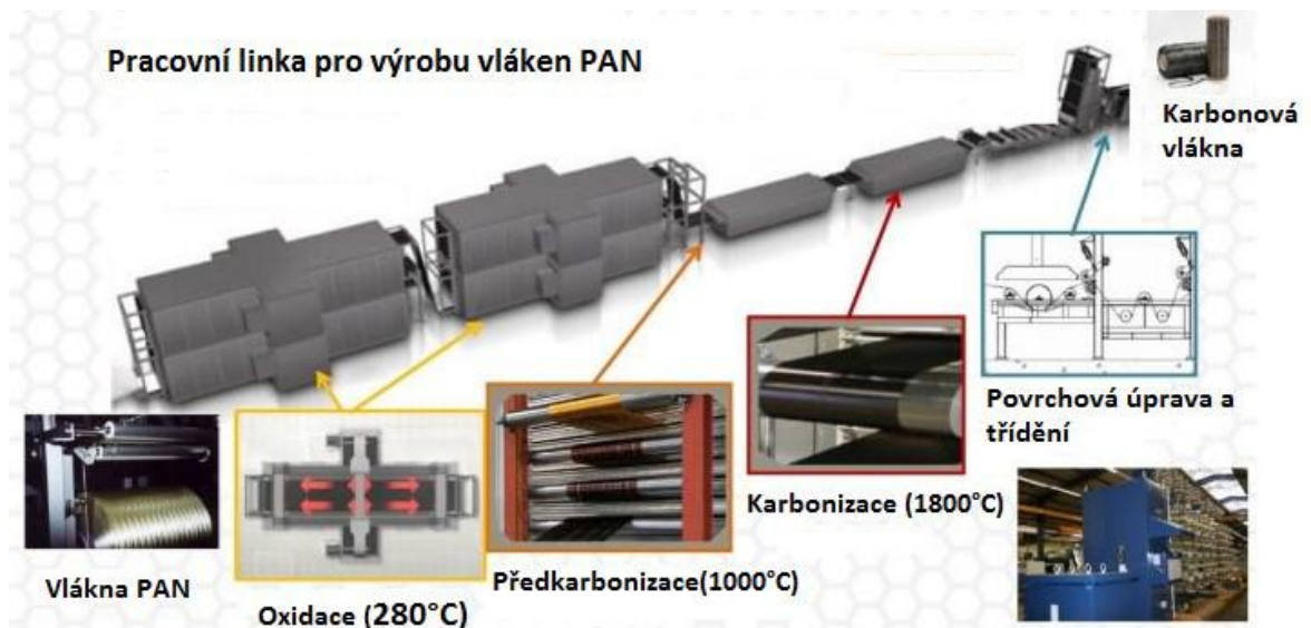
Obr. 11 Pracovní linka pro výrobu vláken PAN [9]
