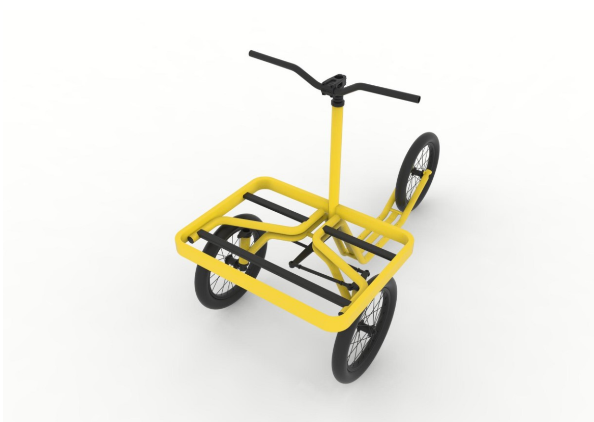
Obr. 35: Konstrukce uchycení kol a plošiny
