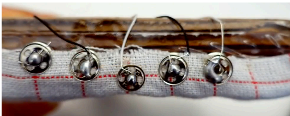
Obrázek č. 11: Jednotlivé elektricky vodivé nitě, hrubou silou vypárané z textilu a napojené a elektrody.
