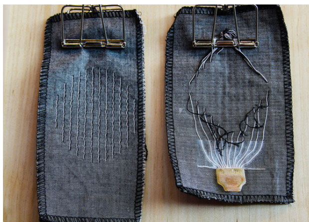
Obrázek č. 2: Příklad začlenění elektricky vodivé dráhy formou zatkáání konduktivní příze již při výrobě materiálu 20 .
