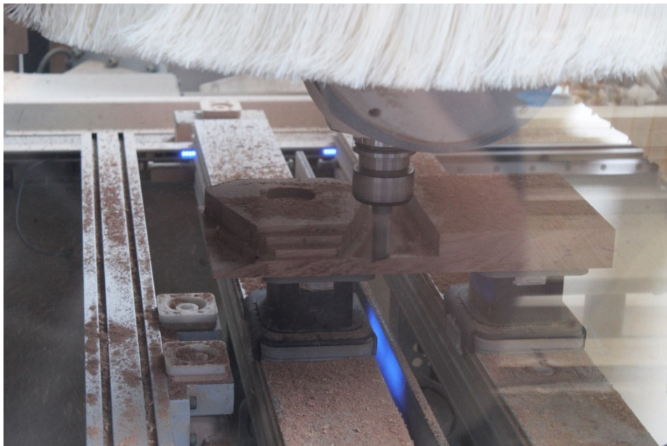
Obrázek 66 Frézování na obráběcím centru Homag
