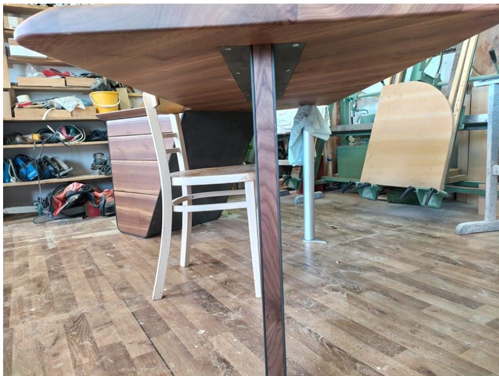
Obr. 51 Nevšední sendvičový systém kov-dřevo-kov
