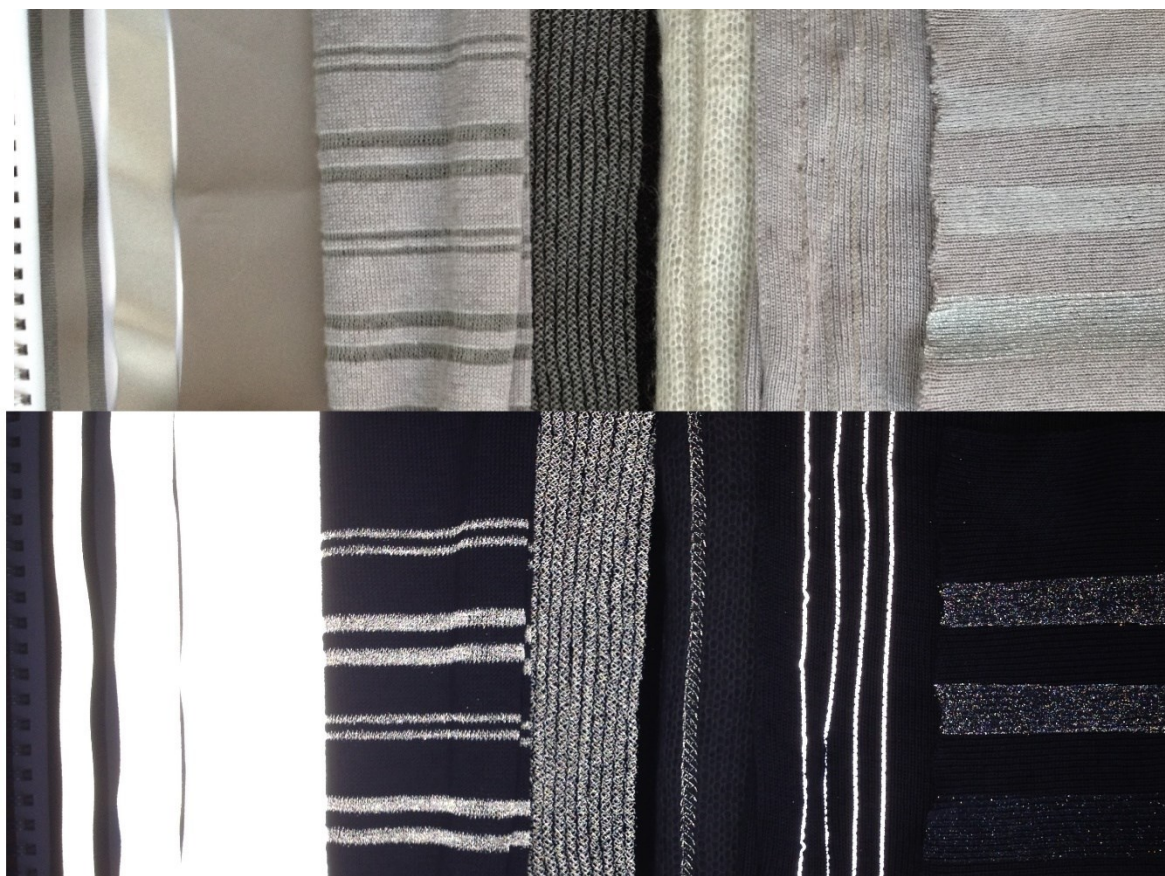
Obr. č. 15 Ukázka fungování retro-reflexních materiálů v denním světle a při nasvícení bleskem. Zleva: retro-reflexní pásky, pletení s retro-reflexní prošívací nití, našitá připlétací příze a retro-reflexní barva
