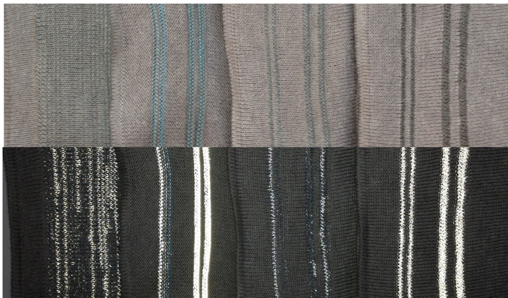
Obr. č. 17 Retro-reflexní nit v různých vazbách pleteniny
