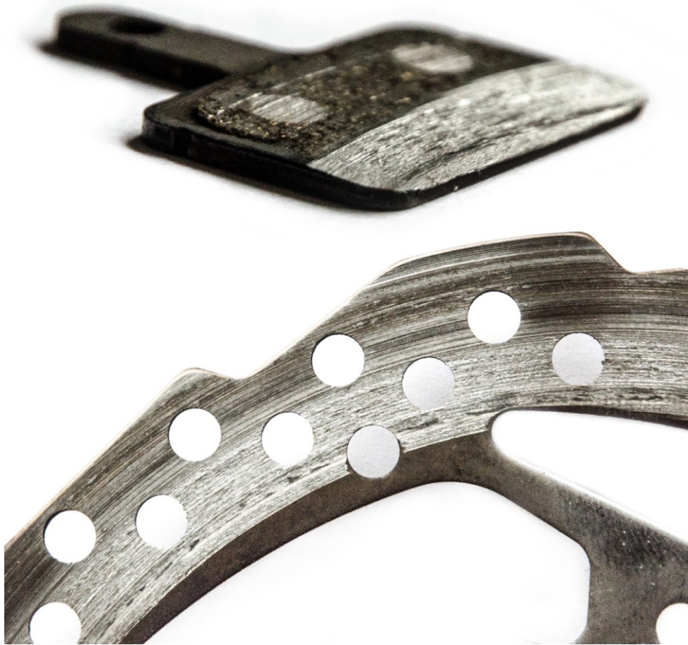
Obrázek 5 překročení životnosti brzdové destičky
