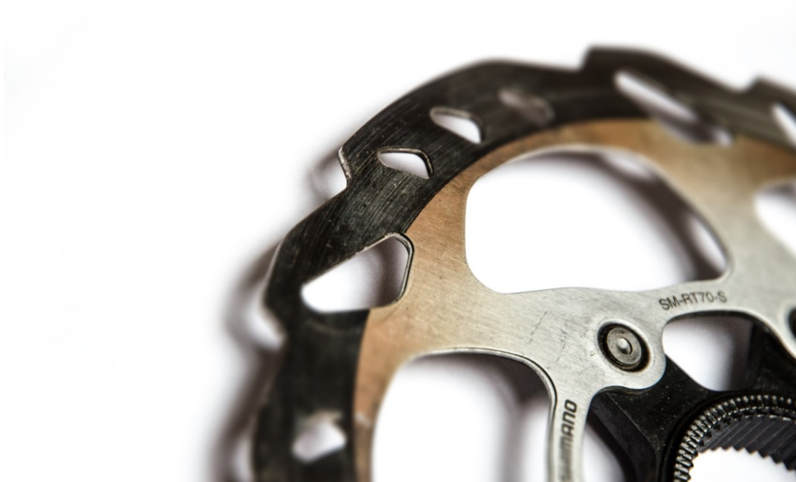
Obrázek 6 Opálený brzdový kotouč
