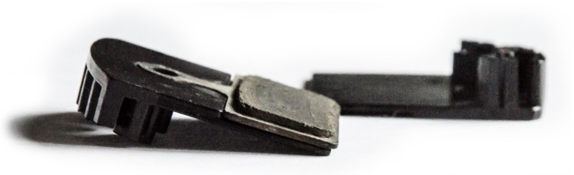
Obrázek 10 Brzdové destičky s přídavnou chladicí vložkou
