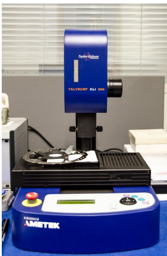
Obrázek 37 Přístroj Talysurf CLI s nastavenou odrazivostí
