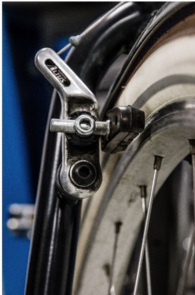
Obrázek 2 Ráfkový brzdny systém
