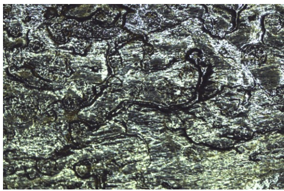
Obrázek 50 – Vzorek B zasažen olejem (NSS-720h), po očištění
