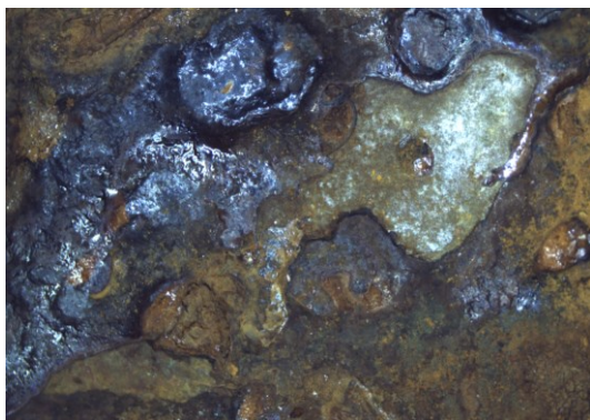
Obrázek 31 – Vzorek B nezasažen (NSS-360h), před očištěním
