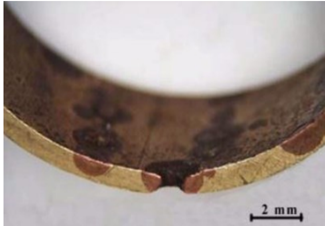
Obrázek 17 – Selektivní koroze- odzinkování mosazi (7)
