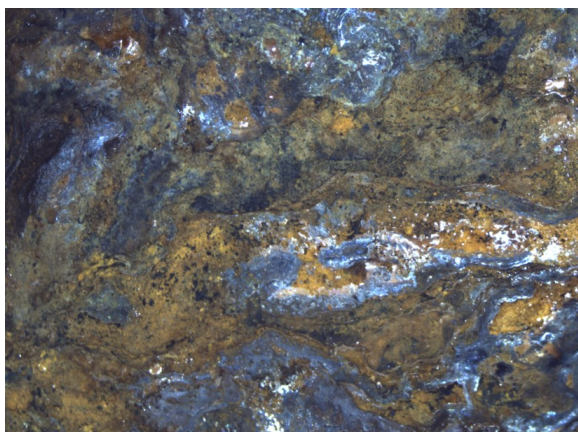
Obrázek 35 – Vzorek B zasažen prachem (NSS-360h), před očištěním
