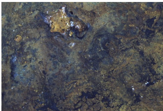
Obrázek 37 – Vzorek B zasažen olejem (NSS-360h), před očištěním
