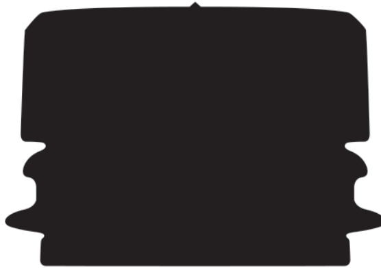
Obrázek 9: Snímek se zadním osvětlením – obrys lahve [5]
