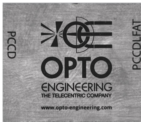
Obrázek 8: Snímek osvětlený koaxiálním osvětlením [5]
