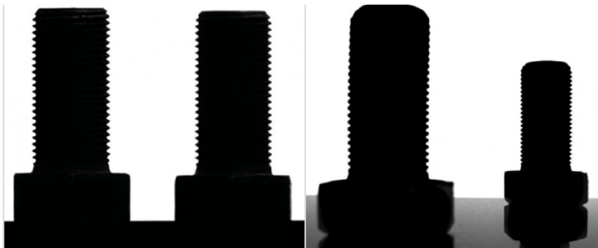
Obrázek 11: Porovnání snímků pořízených telecentrickým (vlevo) a endocentrickým (vpravo) objektivem [5]
