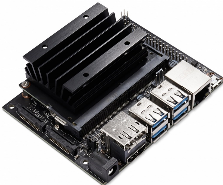
Obrázek 34: Vývojový kit Nvidia Jetson Nano
