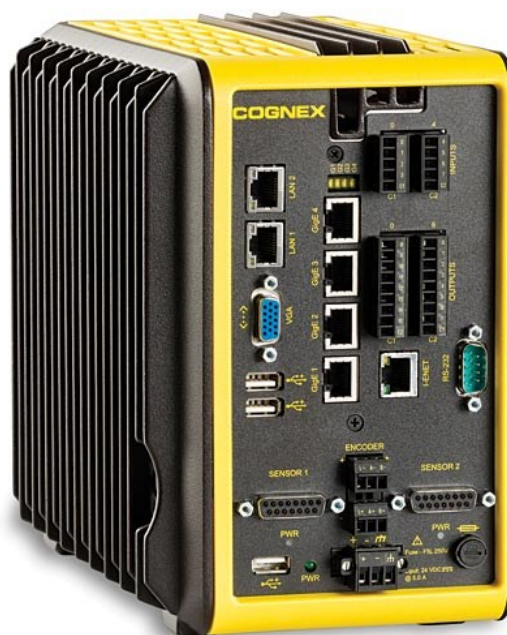
Obrázek 4: Příklad PC kamerového systému – Cognex VC5 [4]
