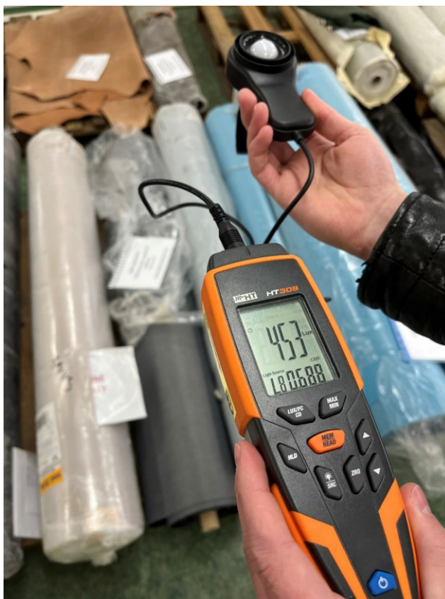
Obrázek 10 Průběh měření osvětlení (zdroj vlastní)
