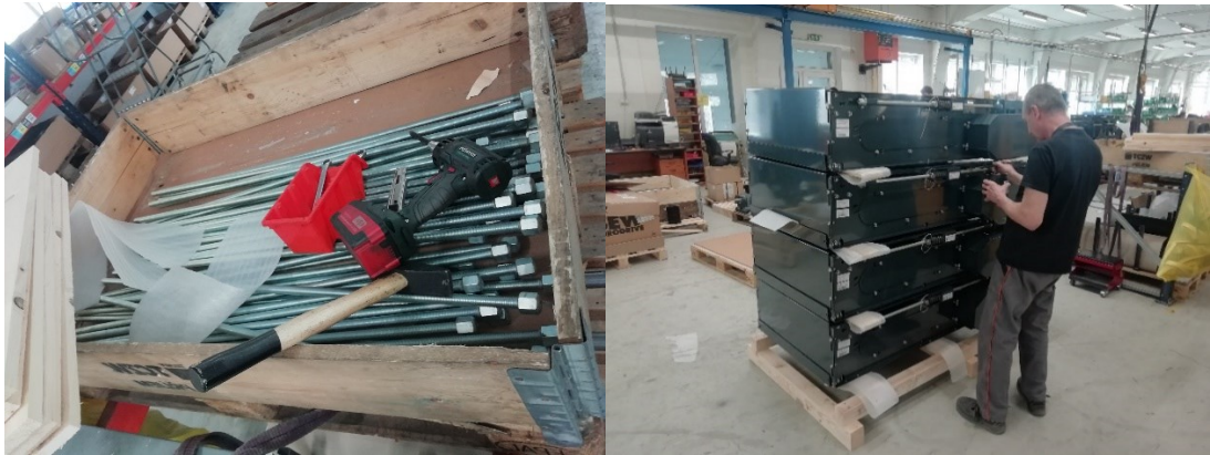
Obrázek 28 – Paleta s náradím na montáž krytu hřídele a finální montáž krytu (Vlastní zpracování)
