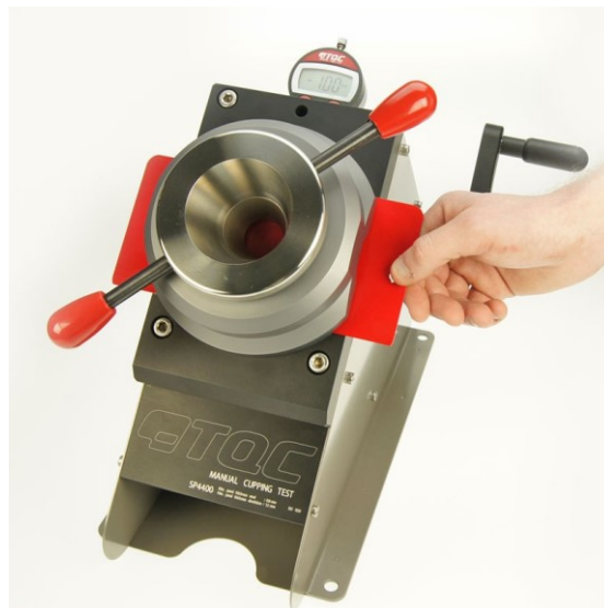
Obr. 15 Příkladová ukázka přístroje pro zkoušku hloubením (Manuální zkouška hloubením (Erichsen), © 2017)
