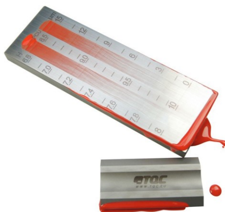
Obr. 18 Příkladová ukázka grindometru (Grindometry, © 2017)
