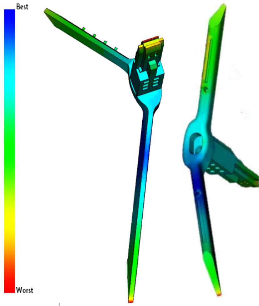
Obrázek 66 – Vhodnost umístění vtokového ústí
