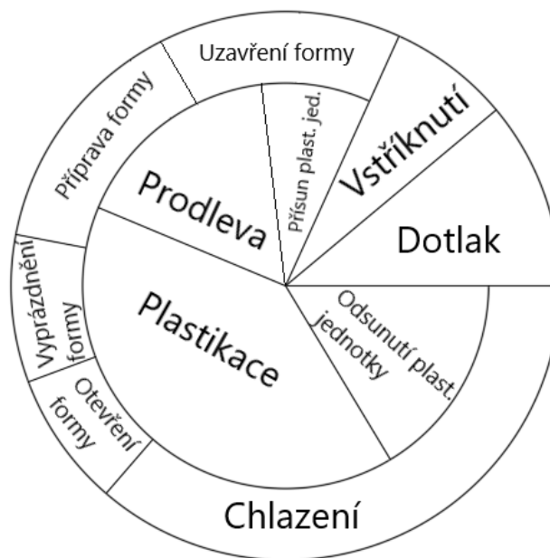
Obrázek 3 – Časový průběh vstřikovacího cyklu
