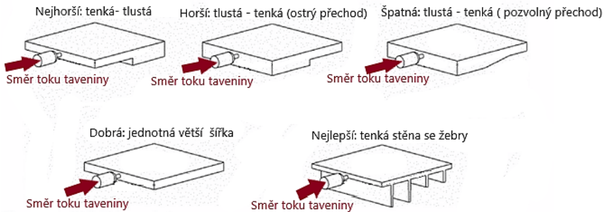
Obrázek 11 – Řešení přechodů tloušťky stěn výrobku [1]
